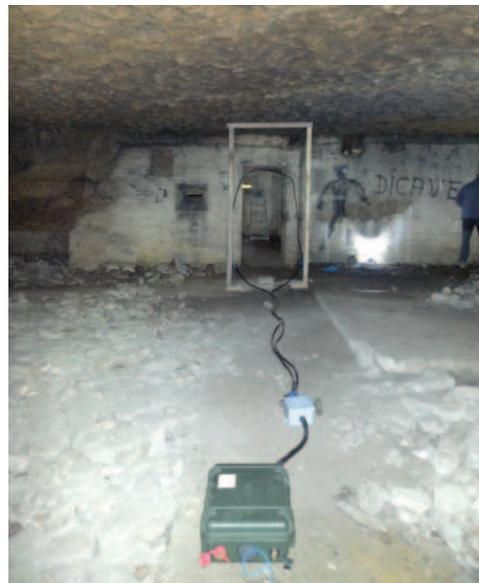
Figure 4 : « Antenne-corde » installée à Saint-Michel-le-Cloucq (85) (Maxime LEUCHTMANN)
