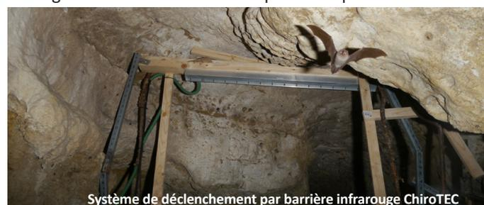
Système de déclenchement par barrière infrarouge ChiroTEC
