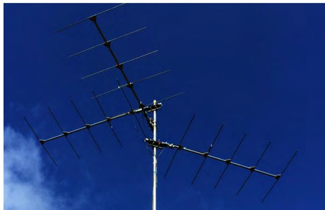
Les antennes utilisées sont des antennes longues avec un gain élevé (jusqu'à 13 dB) ce qui permet de détecter le signal d'une balise jusqu'à environ 20 km. Il est donc possible d'espacer deux stations de réception d'environ 40 km, si une des antennes de chaque station pointe en azimut vers l'autre station.
