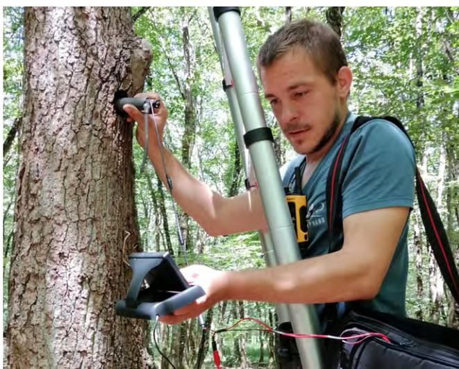
La caméra de cavités se compose d'un tube PVC équipé à l'intérieur d'une petite caméra grand angle de bonne résolution (1080p), et d'un réflecteur permettant de renvoyer la lumière d'une torche (introduite dans le tube) à la perpendiculaire. Le tout est raccordé à une alimentation 12 V et à un petit écran. Après de nombreuses utilisations, ce système a très
