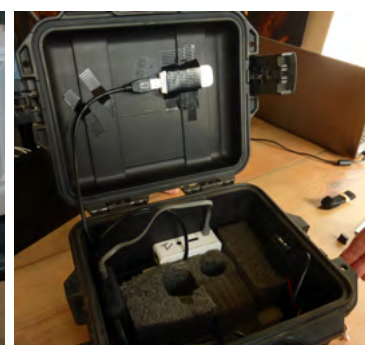
Photo 5 : Balise Raspberry reliée à une clé 4G conçue par GeoEco © GCC
