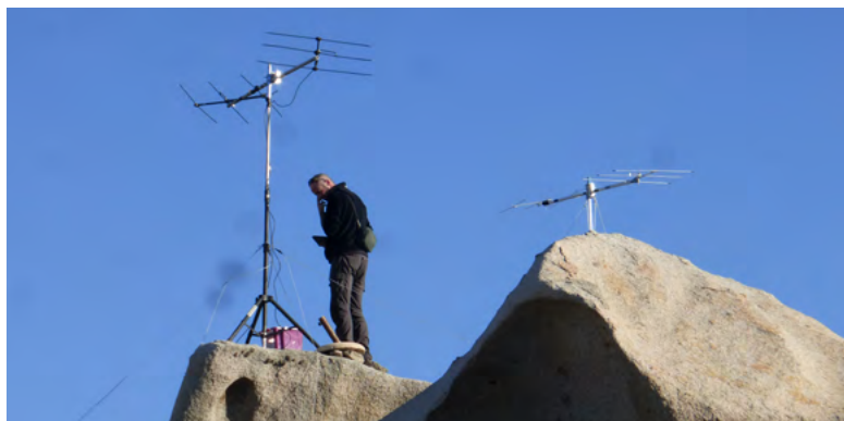
Photo 7 : Positionnement des antennes de réception sur Lavezzi lors d'une opération test © GCC
