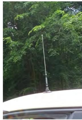
Figure 2. Antenne de toit omnidirectionnelle © V. Louis
