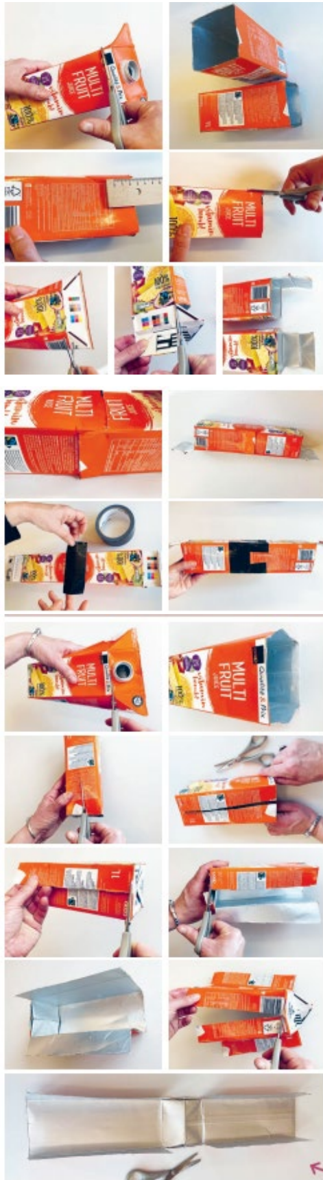
Fig. 6. Etapes pour la fabrication d'un tunnel à empreintes et QR code pour la fabrication en vidéo. Source : Pronatura.
